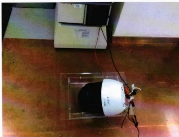
图十三：浪涌（冲击）抗扰度试验检测布置图（网络端口）
