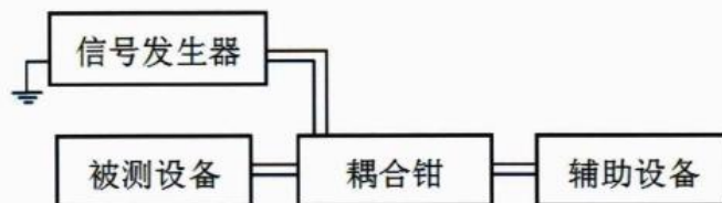
图十：电快速瞬变脉冲群抗扰度试验被测设备的连接图（网络端口）
