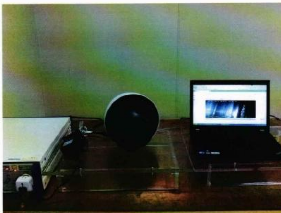
图七：电快速瞬变脉冲群抗扰度试验检测布置图（电源端口）
