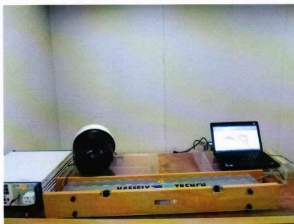
图九：电快速瞬变脉冲群抗扰度检测布置图（网络端口）
