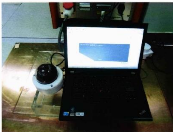
图五：浪涌（冲击）抗扰度试验检测布置图(电源端口)
