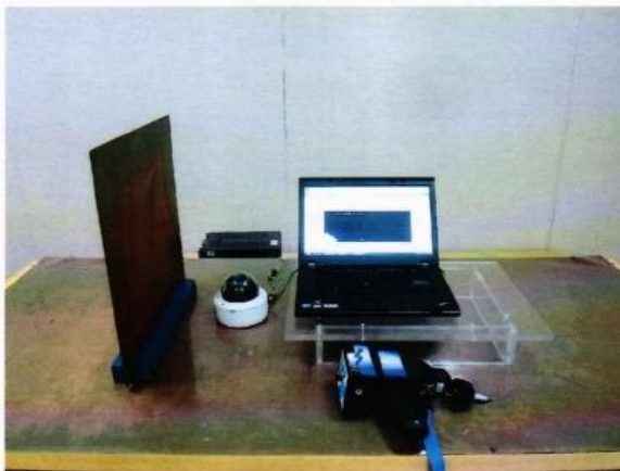
图三：静电放电抗扰度试验检测布置图
