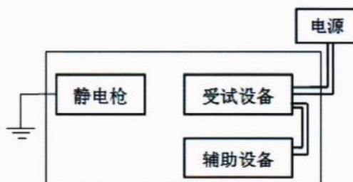
图四：静电放电抗扰度试验被测设备的连接图
